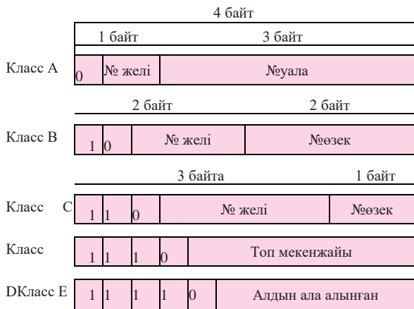
2.4 сурет. IP-мекенжай құрылымы
