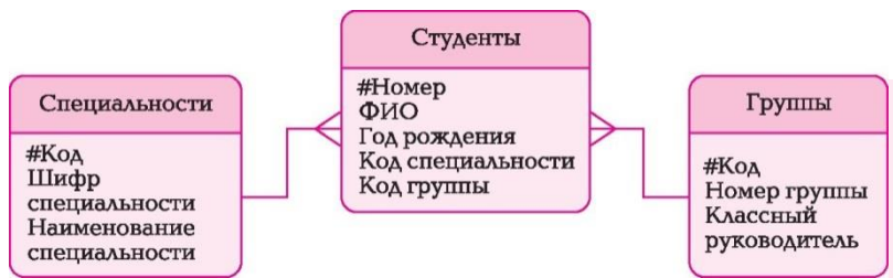
10.15 сурет. 3нф қалыбына келтірілгеннен кейінгі деректер қоры
